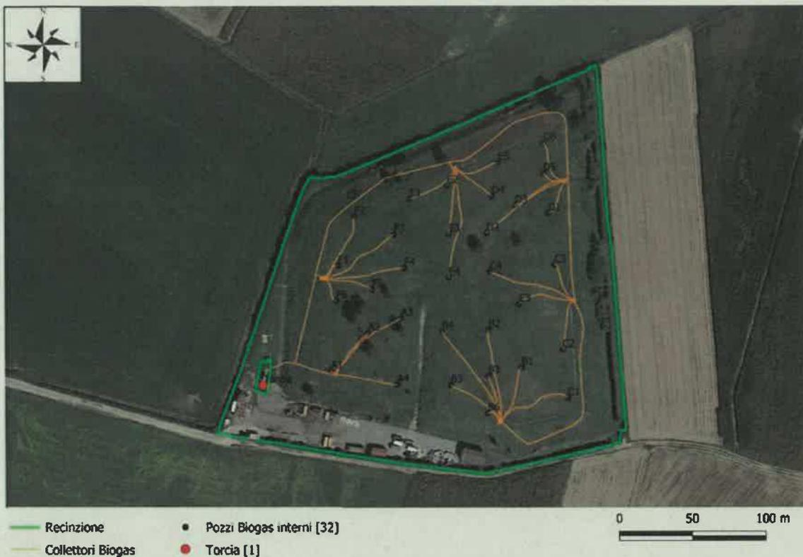
Fig. 1.2– Rete di estrazione forzata del biogas. Scala 1:2000.
