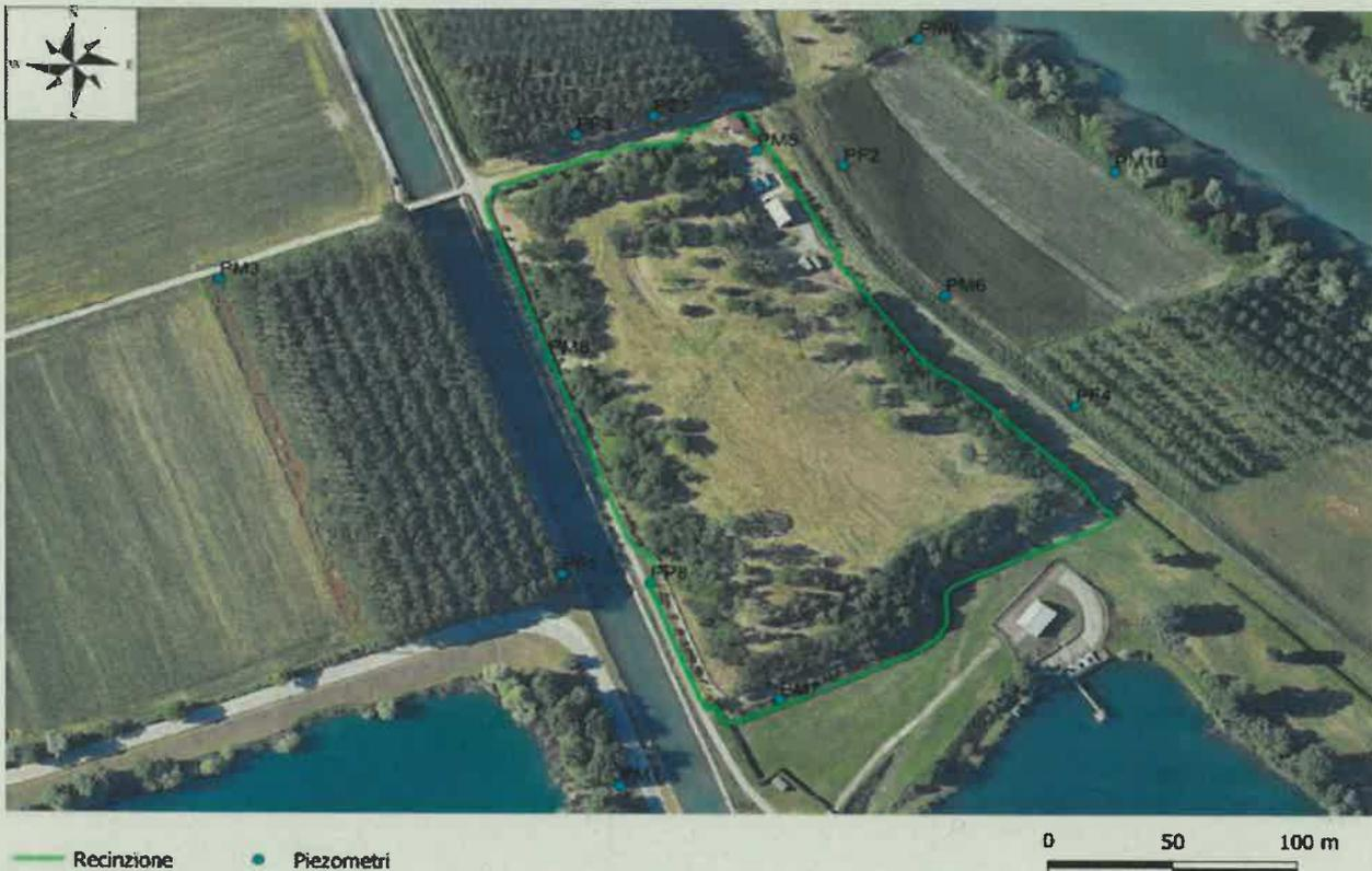
Fig. 1.3 – Rete di monitoraggio acque sotterranee. Scala 1:2.000
