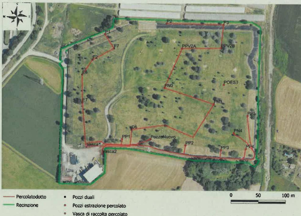
Fig. 1.1 – Rete di estrazione del percolato. Scala 1:2.000
