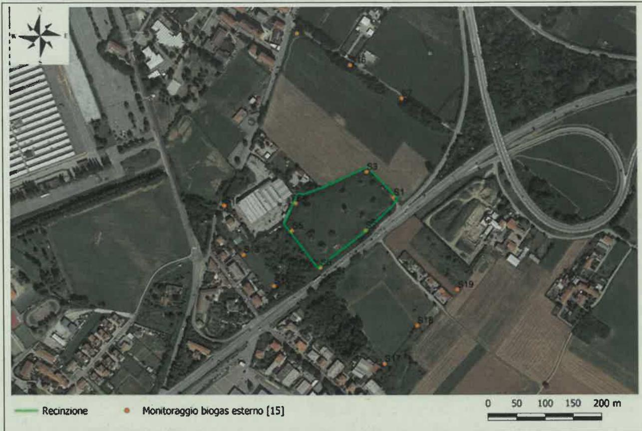
Fig. 1.5– Ubicazione pozzi di monitoraggio del biogas. Scala 1:4000.
